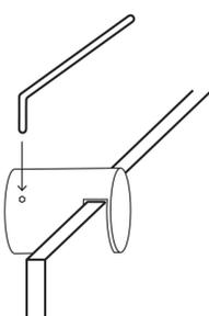
**4** Die Platte mit den Befestigungshülsen verbinden. Anschliessend – ohne die Acrylglasplatte loszulassen – die vier seitlichen Metallschrauben mit dem Inbusschlüssel fest anziehen.
