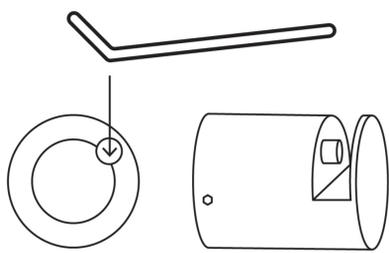
**2** Die vier integrierten Kunststoffschrauben von hinten mit dem Inbusschlüssel fest anziehen. Die Lochabstände jeweils von Mitte zu Mitte der Befestigungslöcher in den Plattenhaltern messen und auf die Wand übertragen.
