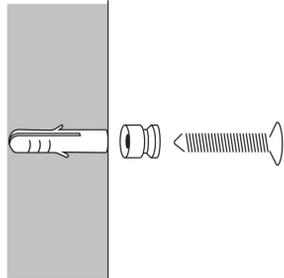
**3** Einen 6-mm-Bohrer benutzen und den Dübel komplett in die Wand drücken. Die Schrauben in die Befestigungshülsen schieben und in die Dübel einschrauben.
